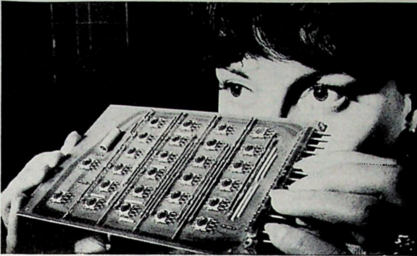
In de Siemens computer type 300 worden geïntegreerde digitale schakelingen volgens de monolytische techniek toegepast. Op een bedradingskaart worden 26 van deze schakelingen ondergebracht. Deze 26 monolytische schakelingen vervangen 52 conventionele digitale circuits.
